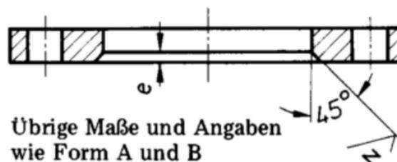
Bezeichnung eines glatten Flansches Form A für Nennweite 100 und Rohr-Außendurchmesser  $d_1 = 114,3$  mm aus RSt 37-2:
